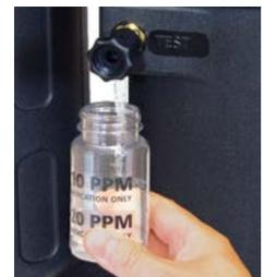
Válvula de teste e garrafa de amostra para testar resíduo de ppm de óleo incluído como padrão
