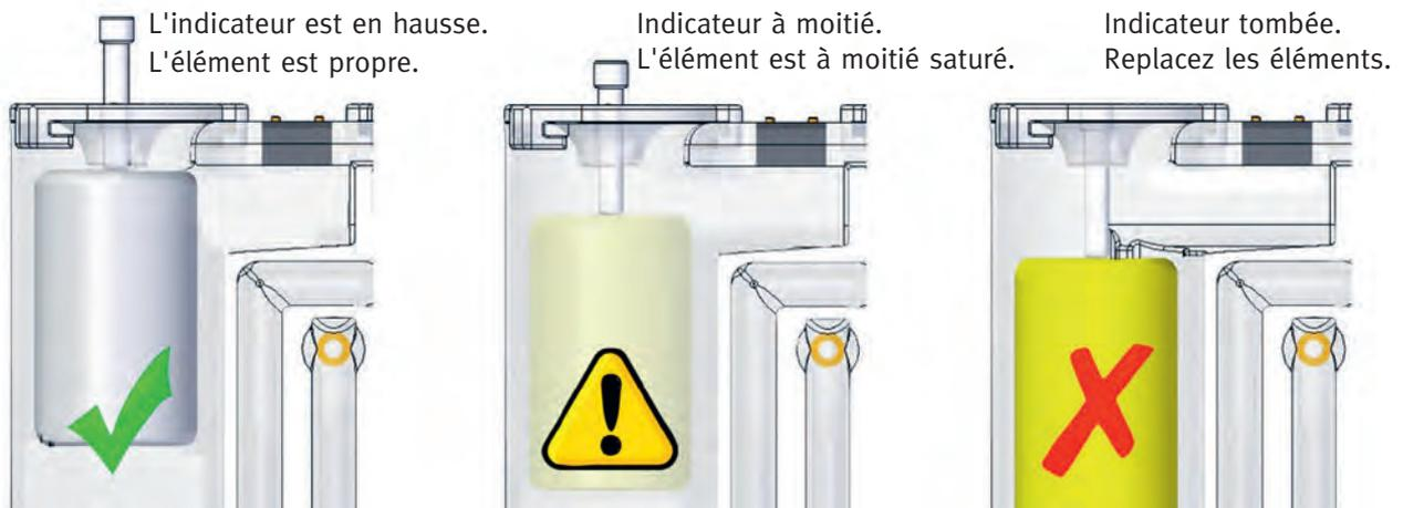
Une caractéristique unique des séparateurs SEPREAMIUM est l'indicateur de durée de vie de l'élément (blanc). Cet indicateur donne une confirmation visuelle instantanée de la condition des éléments dans le séparateur et du moment où ils doivent être remplacés.
