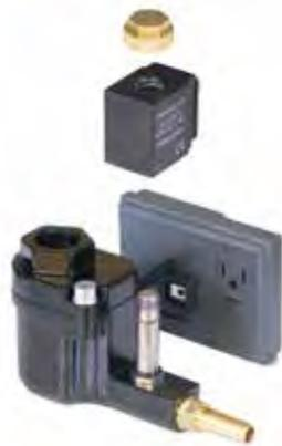
Mantener el KAPTIV-MD no puede ser más fácil. La purga se puede desmontar por medio de destornillar dos tornillos después puede soltar la bobina para tener acceso inmediato a las partes internas de la válvula.
