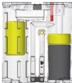
4. L'indicatore rosso si alzerà quando gli elementi saranno completamente saturi e sarà possibile un traboccamento. Questo si verifica per l'intasamento di tutti gli elementi saturi del separatore o per l'ostruirsi del punto di scarico.
