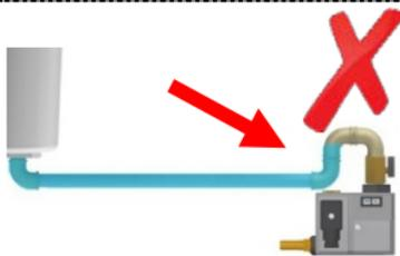
Le tuyau d'évacuation des condensats doit être horizontal ou idéalement avoir une pente descendante ( $>1^\circ$ ).
