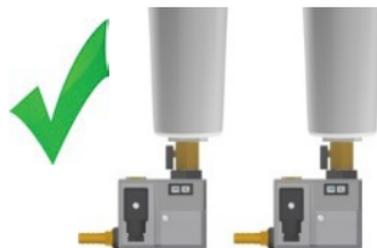
Eviter l'accumulation potentielle d'eau dans le tuyau d'évacuation des condensats lors de son installation, car cela pourrait provoquer un blocage de l'air.
