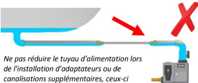
Ne pas réduire le tuyau d'alimentation lors de l'installation d'adaptateurs ou de canalisations supplémentaires, ceux-ci peuvent causer des poches d'air.
