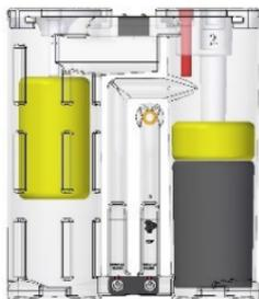
4. L'indicateur rouge sera positionné en haut au moment que le niveau de l'eau dans le séparateur d'eau/huile est trop élevé, et vous avertit que le passage de l'eau peut être bloqué. (par exemple à cause des éléments saturés).
