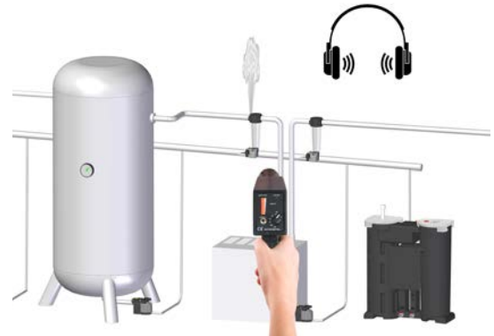
Visuell och hörbar läckageindikering
