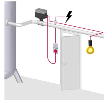
Een typische installatie van een AIR-SAVER-LS, aangesloten op een lichtsckelaar.
