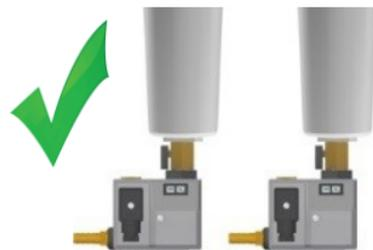
*Si el descenso de la tubería no es suficiente, o si otros problemas del flujo ocurren, un línea de venteo se debe instalar para evitar un bloque de aire.*
