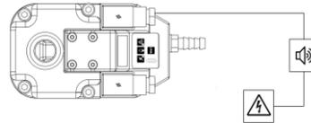
4. Reliez l'alimentation d'énergie au connecteur d'alarme de purgeur pour fermer la boucle.
