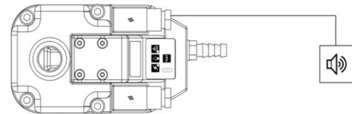
3. Reliez votre dispositif d'alarme à une alimentation d'énergie. Le commutateur d'alarme est de type «contact». Une alimentation d'énergie externe est nécessaire parce que le point de raccordement d'alarme fonctionne seulement.
