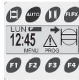
3. Appuyez sur AUTO
