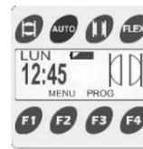
12. a) Les HEURES D'OUVERTURE ET DE FERMETURE DE LA VANNE sont préprogrammées de sorte à assurer l'OUVERTURE DE LA VANNE à 6 h et la FERMETURE DE LA VANNE à 18 h, et ce, du lundi au vendredi. Si les HEURES D'OUVERTURE ET DE FERMETURE DE LA VANNE qui sont préprogrammées sont adaptées à votre application, l'unité est à présent paramétrée et prête à l'emploi.
