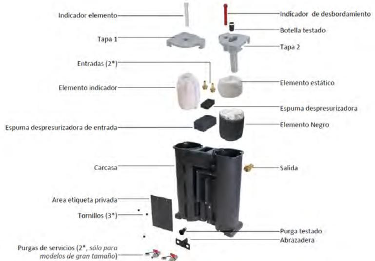
Los modelos SEPREAMIUM tienen tres elementos de alto rendimiento que consisten en dos elementos de fibra de polipropileno y un elemento de carbón activado.
