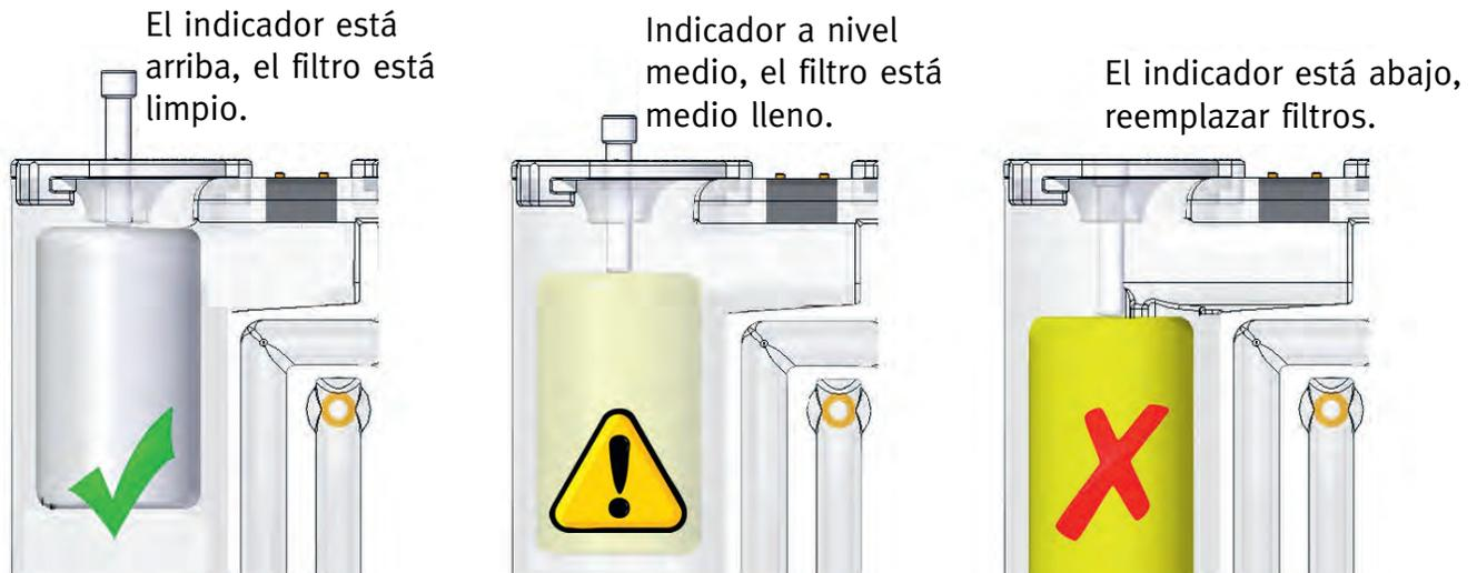
Una característica única de los separadores SEP premium es el indicador de Vida del elemento. Este indicador proporciona una confirmación visual instantánea de la condición de los elementos en el separador y cuándo deben reemplazarse.
