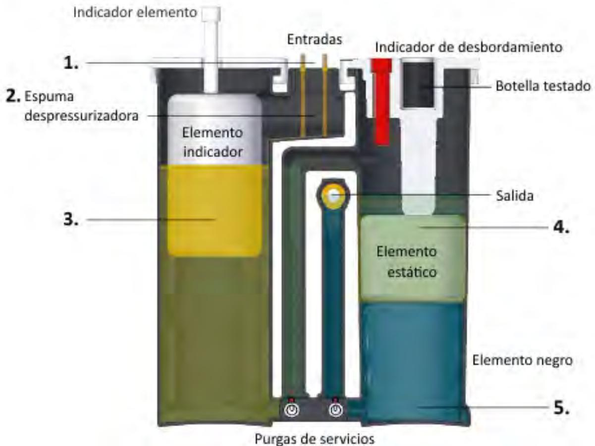
1. Condensado entra en los puertos de entrada de latón. A diferencia de los separadores tradicionales que requieren el uso de drenajes de pérdida de aire cero para reducir la emulsificación, el SEPREAMIUM puede aceptar y separar, de manera efectiva, prácticamente cualquier condensado de cualquier fuente que use cualquier tipo de drenaje.
