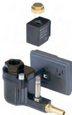
Entretien du KAPTIV-MD ne pouvait pas être plus facile. Le drain se détache en dévissant les deux vis. Vous soulevez la bobine de la tige de valve et vous avez accès direct ensemble de soupape.
