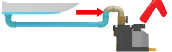
Le tuyau d'évacuation des condensats doit être horizontal ou idéalement avoir une pente descendante ( $>1^\circ$ ).
