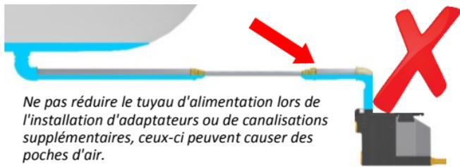
Nous recommandons l'installation de matériels suivants : tuyau d'évacuation des condensats diamètre 1/2", coude à 90° G1/2" et une conduite d'équilibrage 1/2" afin d'éviter la création d'une poche d'air.
