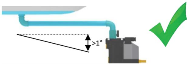
Si la pente d'évacuation des condensats n'est pas suffisante, ou si n'importe quel problème de débit survient, alors une conduite d'équilibrage d'air doit être installée afin d'éviter la création d'une poche d'air.
